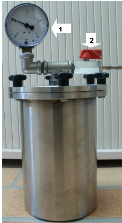
Abbildung 33: Gas befüllbarer Druckbehälter aus Stahl (IMW Eigenbau) zur Kultivierung von Reinigungsaustrichen anaerober Mikroorganismen aus Biogasanlagen; 1 Manometer von -1 bar bis 3 bar; 2 verschließbares Ventil zur Be- und Entgasung.
